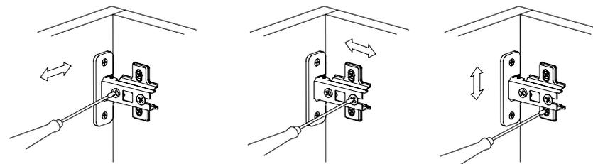
Регулировка вперед - назад. Регулируется крепежным винтом
