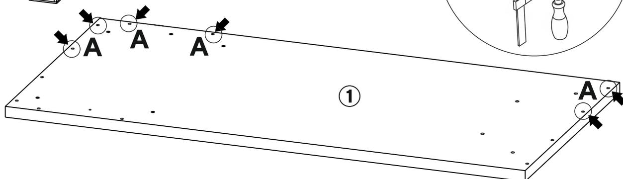
В детали 1 выполнены 12 технологических глухих отверстий для возможного крепления полки из серии Оптима. Если полка не будет устанавливаться, закройте неиспользуемые технологические отверстия заглушками-пробками 8 мм на последнем этапе сборки изделия.
