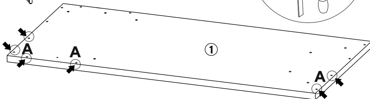
В детали 1 выполнены 12 технологических глухих отверстий для возможного крепления полки из серии Оптима. Если полка не будет устанавливаться, закройте неиспользуемые технологические отверстия заглушками-пробками 8 мм на последнем этапе сборки изделия.
