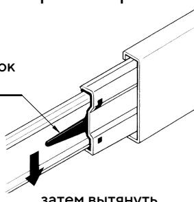
Отсоедините от основания телескопических направляющих внутренние планки, отогнув пластиковый рычажок фиксатора.
