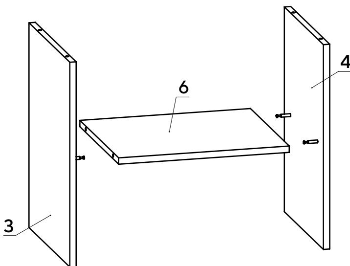
Установите деталь 6 между деталями 3, 4 и затяните головки минификсов.
