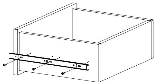
Закрепите внутренние планки направляющих на деталях 8 и 9 шурупами 3,5x16.
