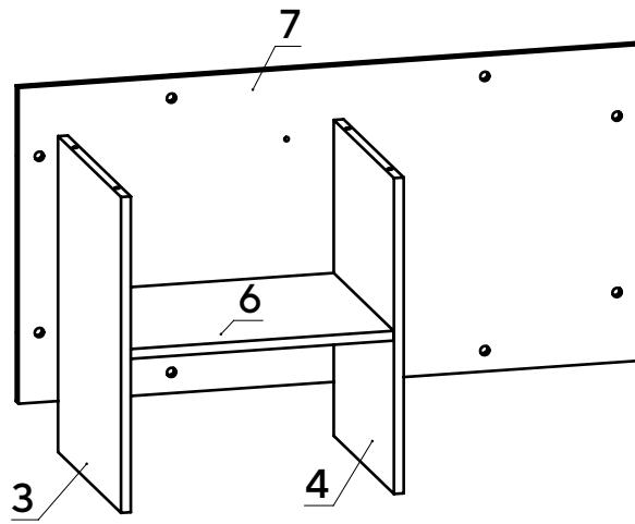
Установите деталь 7 на деталь 3 и затяните головки минификсов. Деталь 7 с деталью 4 соедините при помощи конфирматов.
