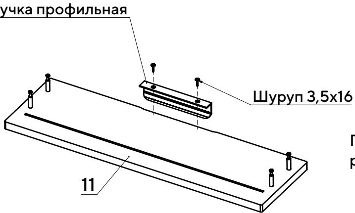
При помощи шурупов 3,5x16 прикрутите ручку профильную к фасаду 11.
