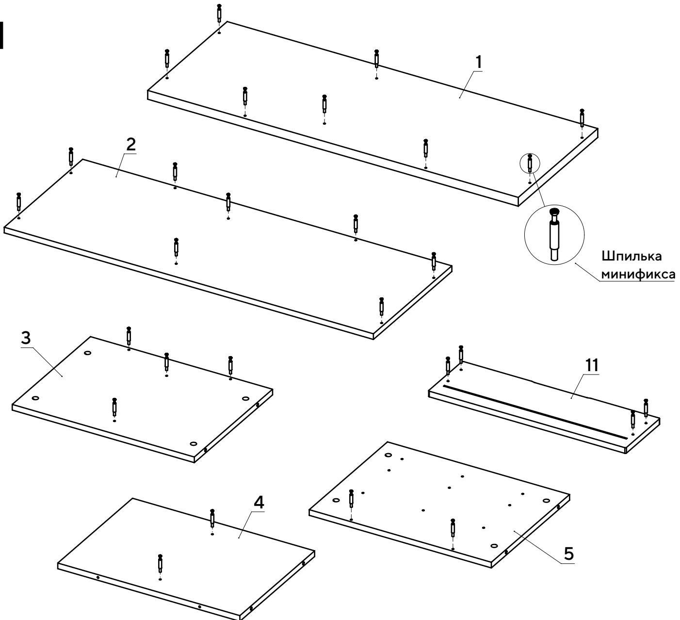
Вкрутите шпильки минификсов в детали 1, 2, 3, 4, 5, 11.
