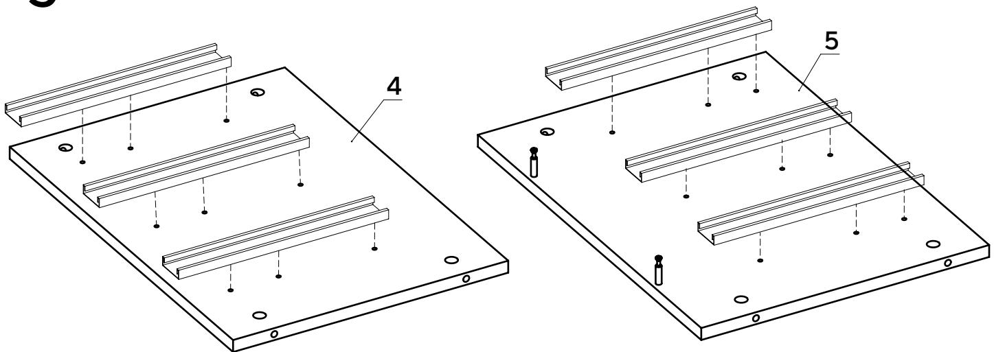
Основания телескопических направляющих закрепите на деталях 4, 5 винтами M5x8.
