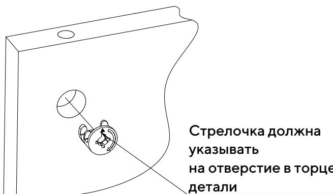
Вставьте головки минификсов в детали 3, 4, 5, 6, 7, 8, 9.
