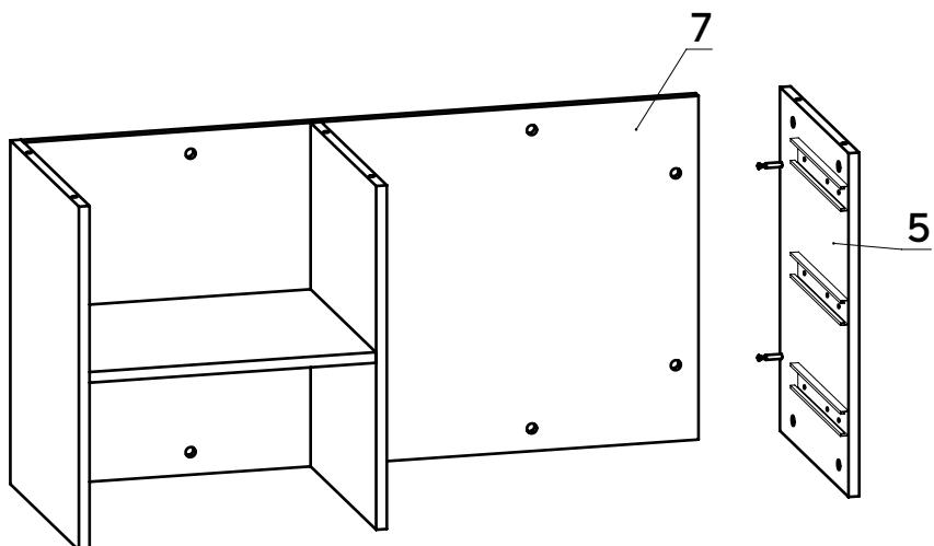
Установите деталь 5 на деталь 7 и затяните головки минификсов.
