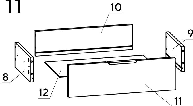
Соедините детали 8 и 9 с деталью 10 при помощи конфирматов. Вставьте дно ящика 12 из ДВП в пазы деталей 8, 9, 10. Соедините деталь 11 с полученной конструкцией и затяните головки минификсов.
