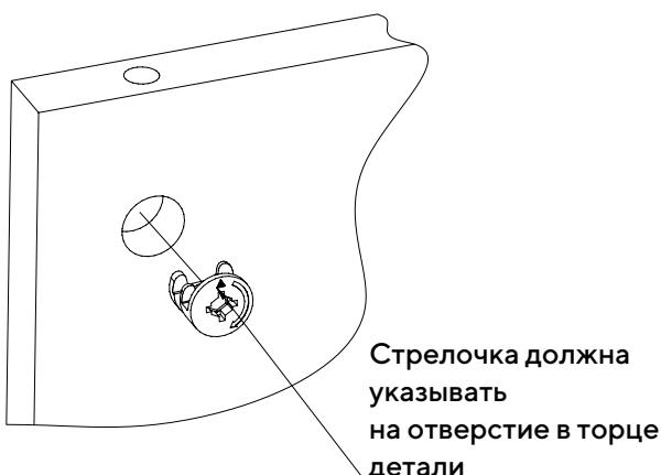
Вставьте головки минификсов в детали 2, 3, 4.
