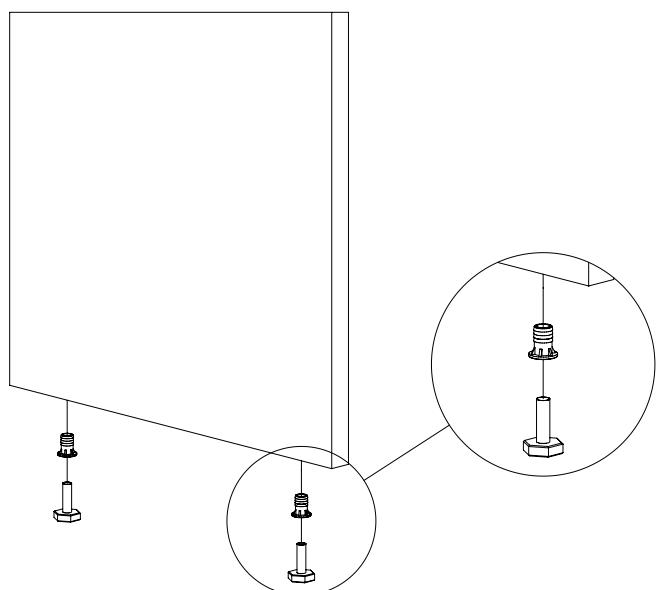
В детали 2 установите муфты забивные для опоры. В муфты забивные вкрутите опоры регулируемые М6.
