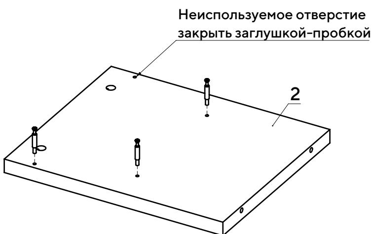
Вкрутите шпильки минификсов в детали 1, 2.
