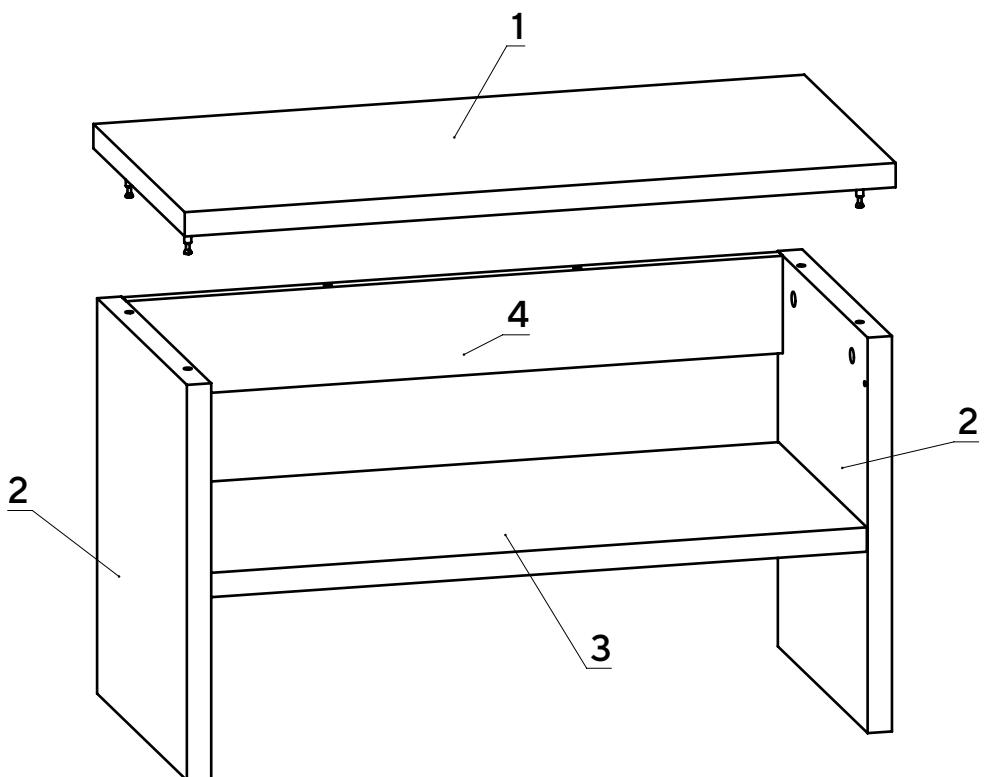
Установите деталь 1 на детали 2, 4 и затяните конфирматным ключом головки минификсов по часовой стрелке до упора.
