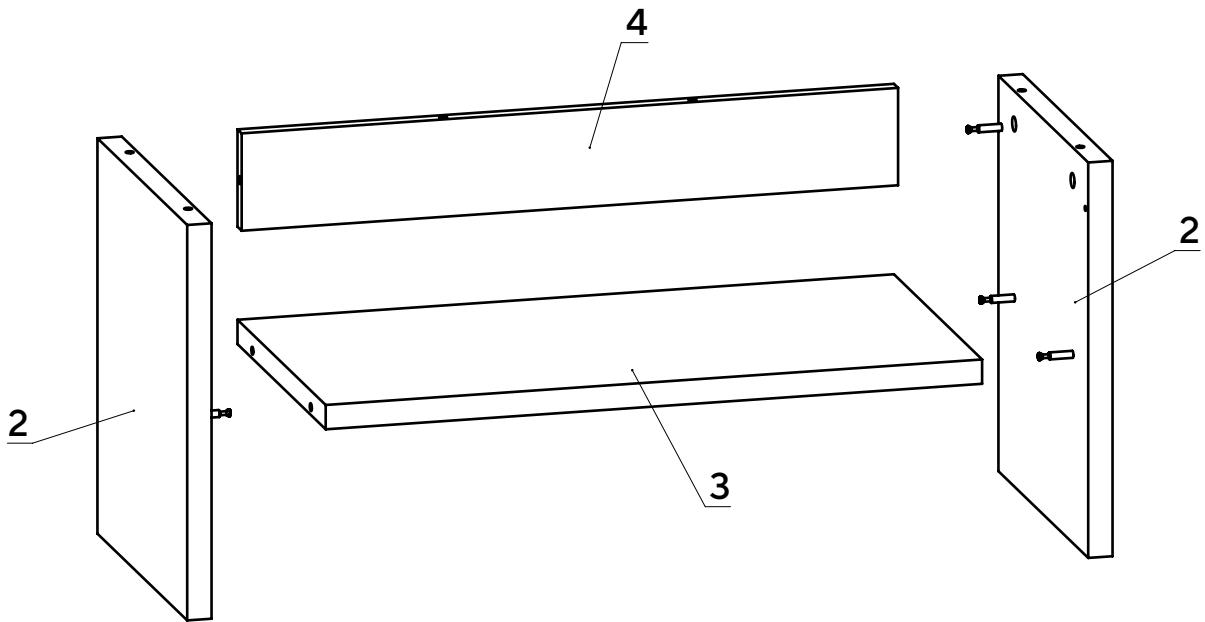
Установите детали 3, 4 между деталями 2 и затяните конфирматным ключом головки минификсов по часовой стрелке до упора.
