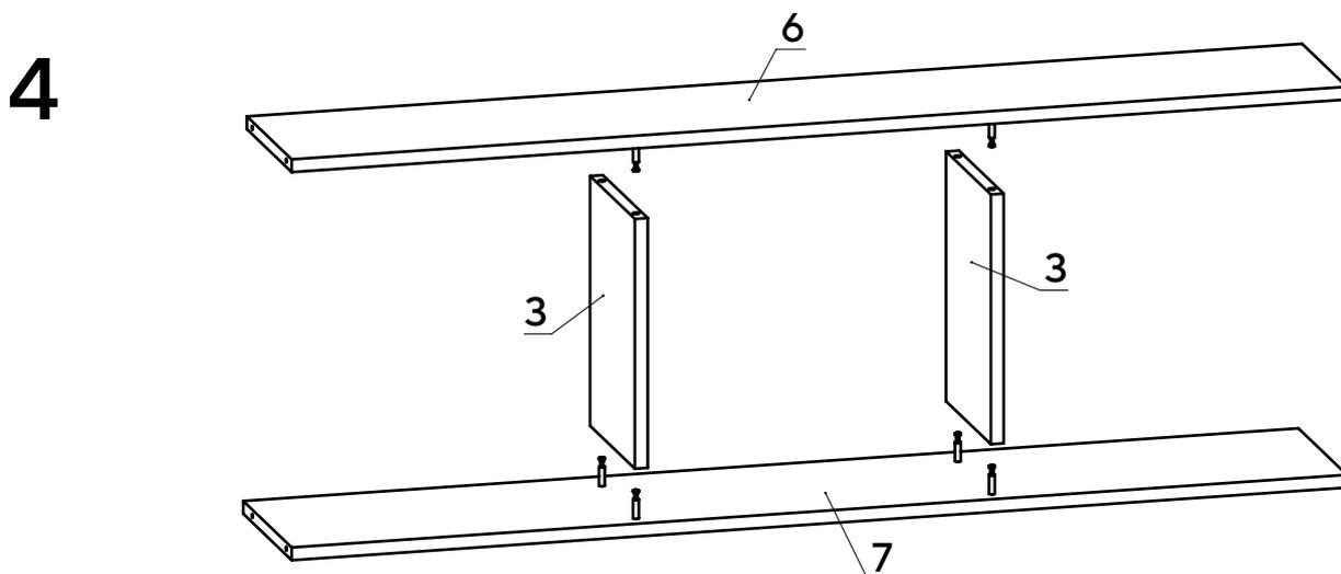
Установите детали 3 между деталями 6 и 7 и затяните головки минификсов.
