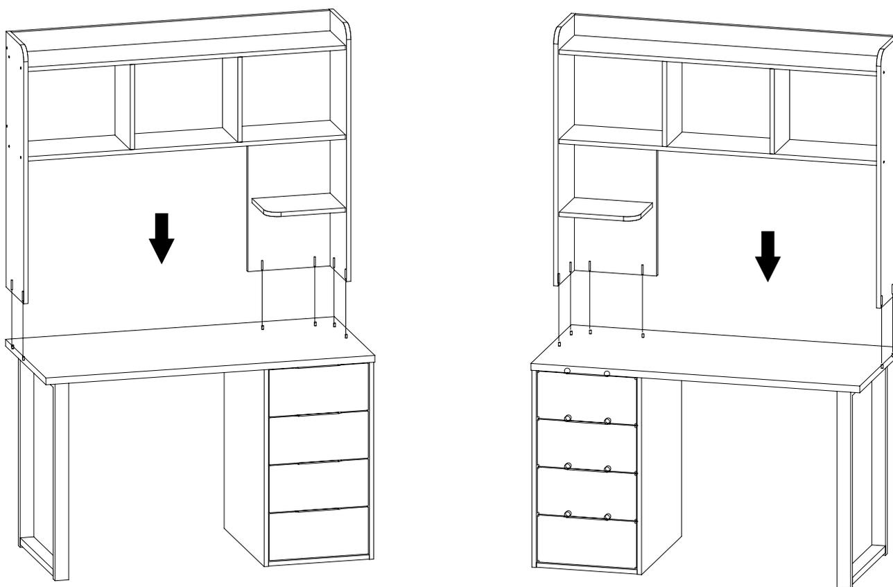
Если полка П-102 будет использована в качестве надстройки столов С-402, С-412, то для установки необходимо досверлить имеющиеся 6 глухих отверстий  $\varnothing 8$  мм в предварительно снятой детали 1 стола.
