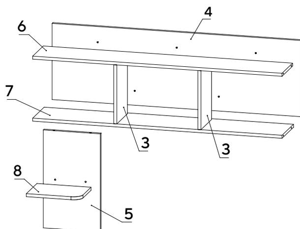
Закрепите деталь 4 к деталям 3, 6 при помощи конфирматов 7x50. Закрепите детали 5 и 8 при помощи конфирматов 7x50. Установите деталь 5 на деталь 7 и затяните головки минификсов.
