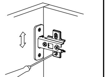
Регулировка вперед-назад. Регулируется крепежным винтом
