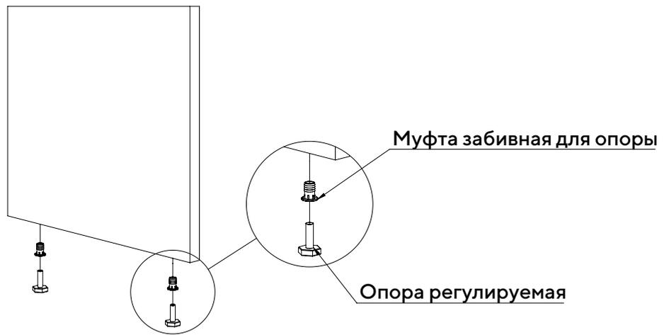
В торцы деталей 2, 3 вбейте муфты забивные для опор. В муфты вкрутите опоры регулируемые.
