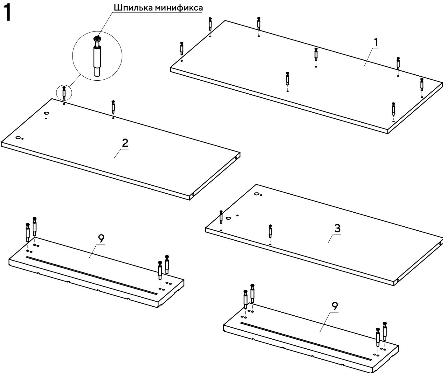
Вкрутите шпильки минификсов в детали 1, 2, 3, 9.
