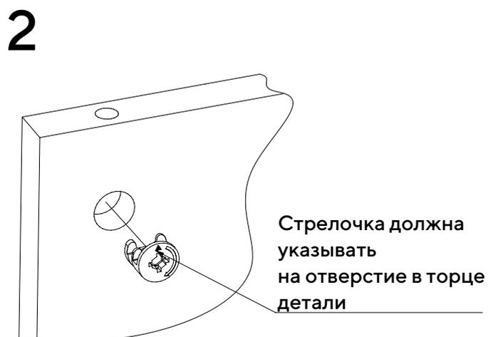
Вставьте головки минификсов в детали 2, 3, 4, 5, 6, 7.
