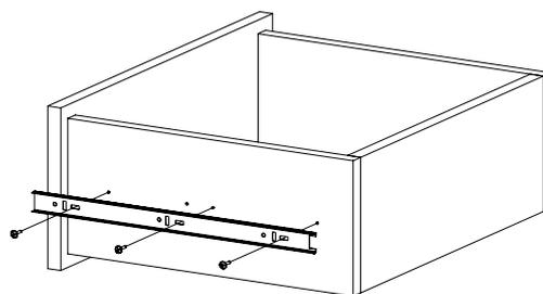
Закрепите внутренние планки направляющих на деталях 6 и 7 шурупами 3,5x16. При необходимости регулировки ящика выкрутите шурупы из круглых отверстий и перекрутите в овальные (продольные и вертикальные регулировочные отверстия). Не затягивая до конца шурупы, сместите ответную планку вверх-вниз. Затяните шурупы до конца.
