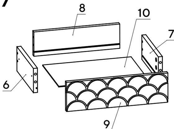
Соедините детали 6 и 7 с деталью 8 при помощи конфирматов. Вставьте дно ящика 10 из ДВП в пазы деталей 6, 7, 8. Соедините деталь 9 с полученной конструкцией и затяните головки минификсов.
