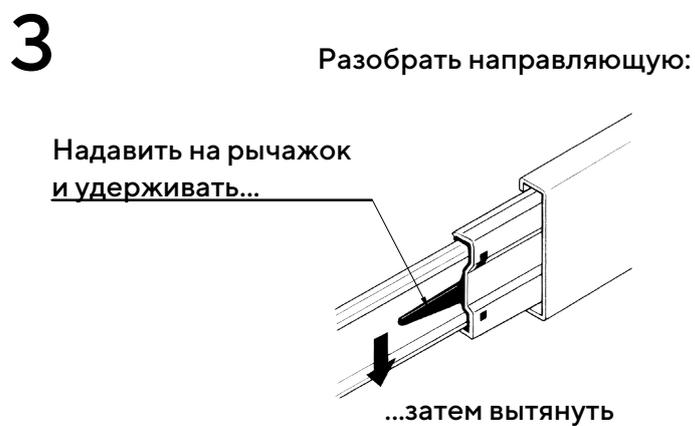
Отсоедините от основания телескопических направляющих внутренние планки, отогнув пластиковый рычажок фиксатора.
