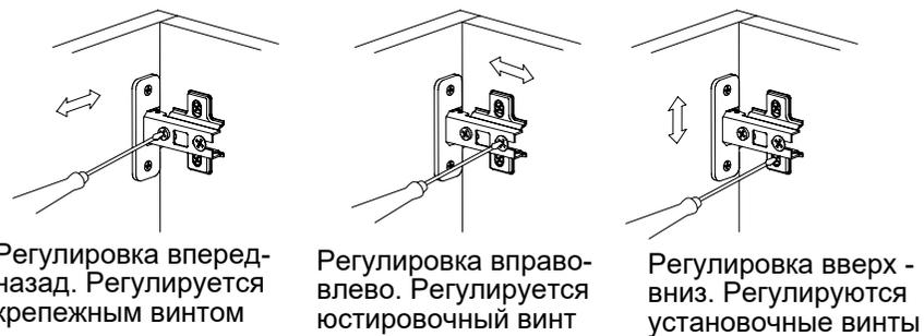
Регулировка вперед-назад. Регулируется крепежным винтом
