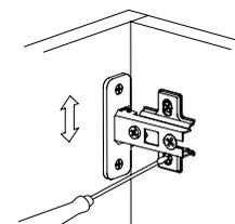
Регулировка вверх-вниз. Регулируются установочные винты
