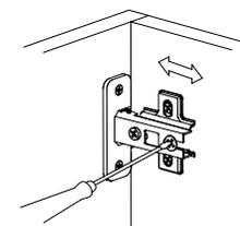
Регулировка вправо-влево. Регулируется юстировочный винт
