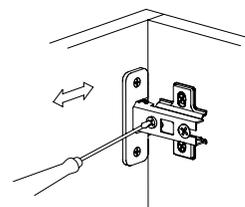
Регулировка вперед-назад. Регулируется крепежным винтом
